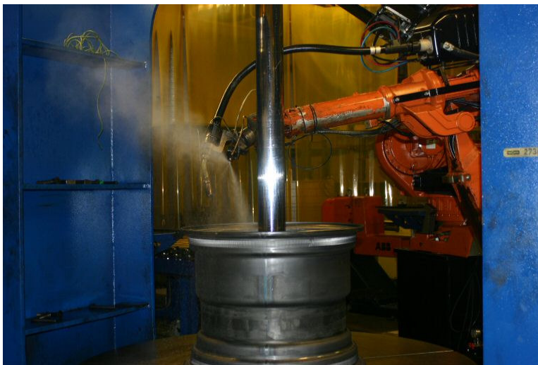
Her bliver svejse-sprøgen påført automatisk umiddelbart inden svejsning.
