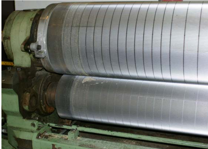
En af de dampopvarmede riffelvalser. For at overskydende lim ikke skal blive siddende på valserne er de i forbindelse med vedligehold forinden smurt med slipmidlet JAX Food Grade Mold Release
